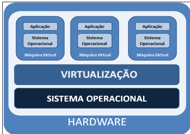
Figura 2 - Modelo clássico de virtualização em Computação em Nuvem.
