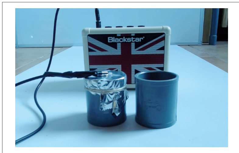
Figura 3: Imagen del micrófono. Un trozo de papel de aluminio envuelve uno de los extremos de un tubo de PVC. Un motor eléctrico de cepillo de dientes se mantiene pegado al papel de aluminio mediante un imán localizado en la cara del papel de aluminio que da al interior del tubo. El motor está soldado a un cable de audio en un extremo, mientras que en el otro extremo hay un jack de audio conectado a un altavoz amplificado.
