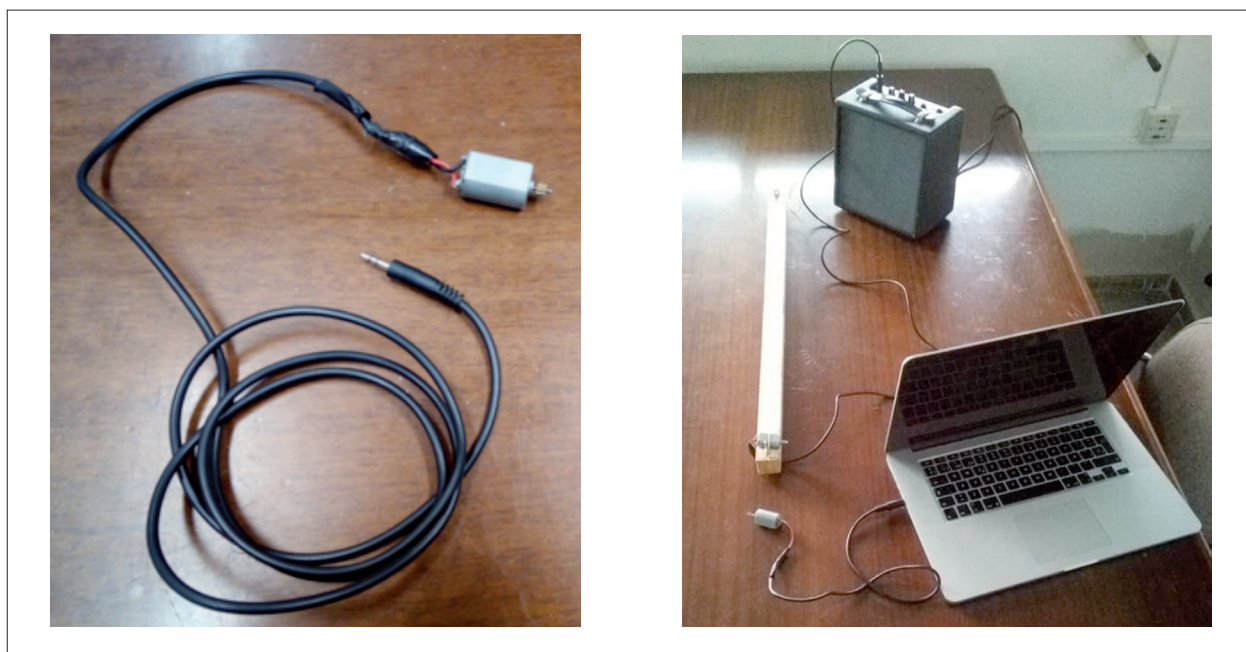
Figura 1: A la izquierda se muestra la conexión básica del motor eléctrico a un cable de audio. A la derecha se pueden observar las dos configuraciones de conexión del motor: desde un equipo de sonido (como un ordenador) al motor y desde el motor (en este caso como parte de una guitarra eléctrica básica) a un altavoz amplificado.
