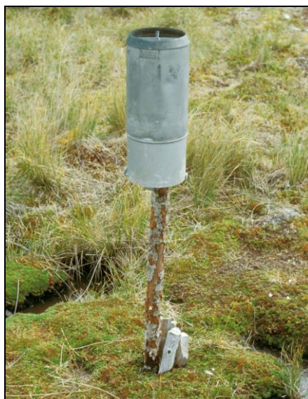
Abb. 4.9 Niederschlagsmesser nach Hellmann, Puerto Bahamondes.
