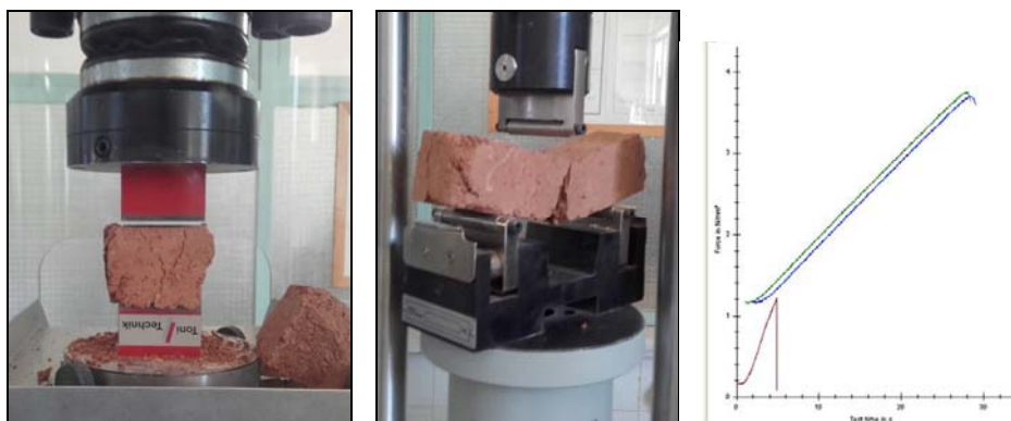
Εικόνα 4.11: Πειραματικές διατάξεις και αποτελέσματα αντοχής σε θλίψη και κάμψη τριών σημείων κονιαμάτων άψητης γης
