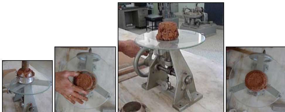
Εικόνα 4.8: Εξέταση δοκιμίου στην τράπεζα εξαπλώσεως
