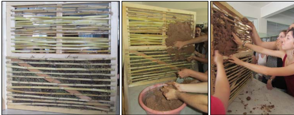
Εικόνα 1.3: Πειραματικός ξυλόπηκτος τοίχος στο εργαστήριο
