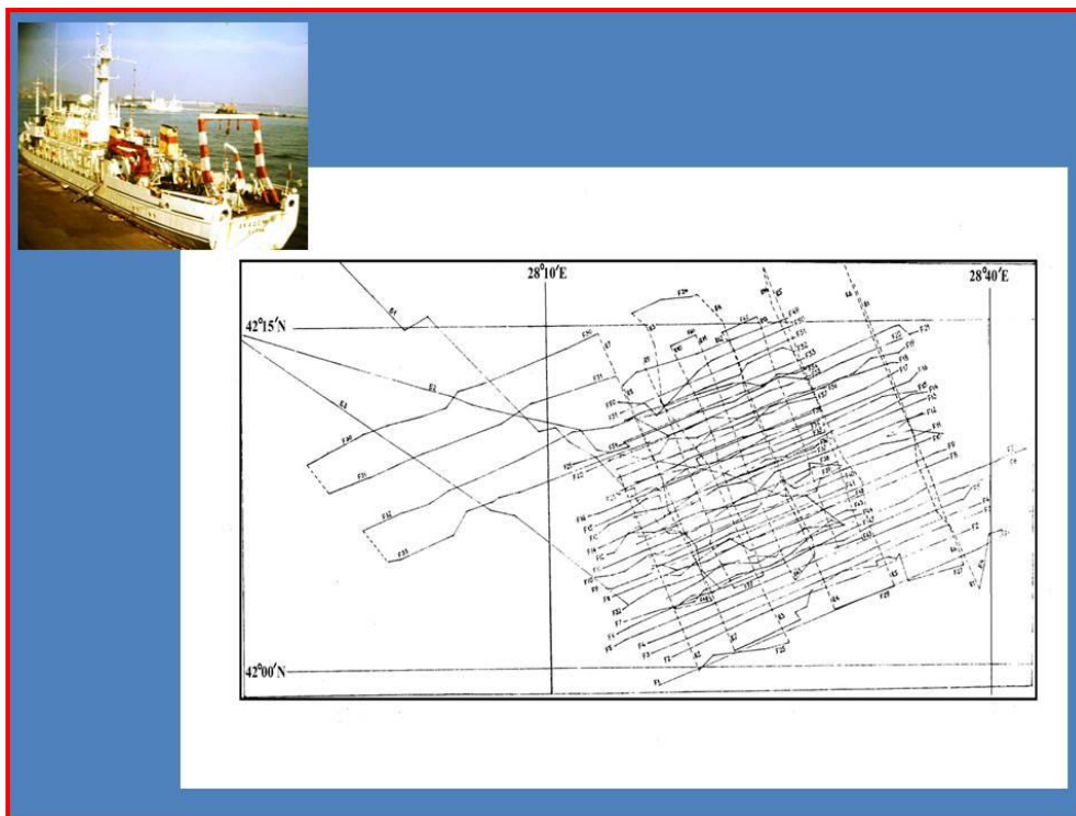
Рис.3. Схема расположения маршрутных съёмочных галсов судна на полигоне П1.
