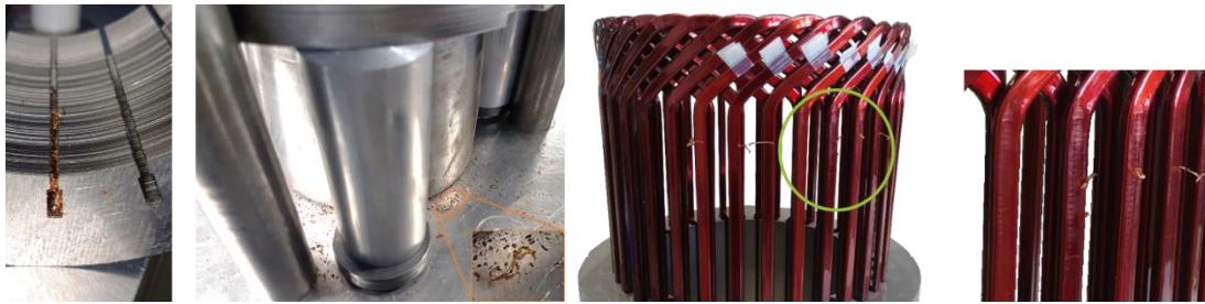
Abbildung 24: Blechpaket (ohne Nutisolation) für experimentelle Montageuntersuchungen
