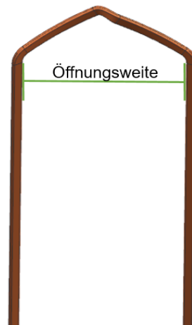
Abbildung 25: Öffnungsweite eines Hairpins
