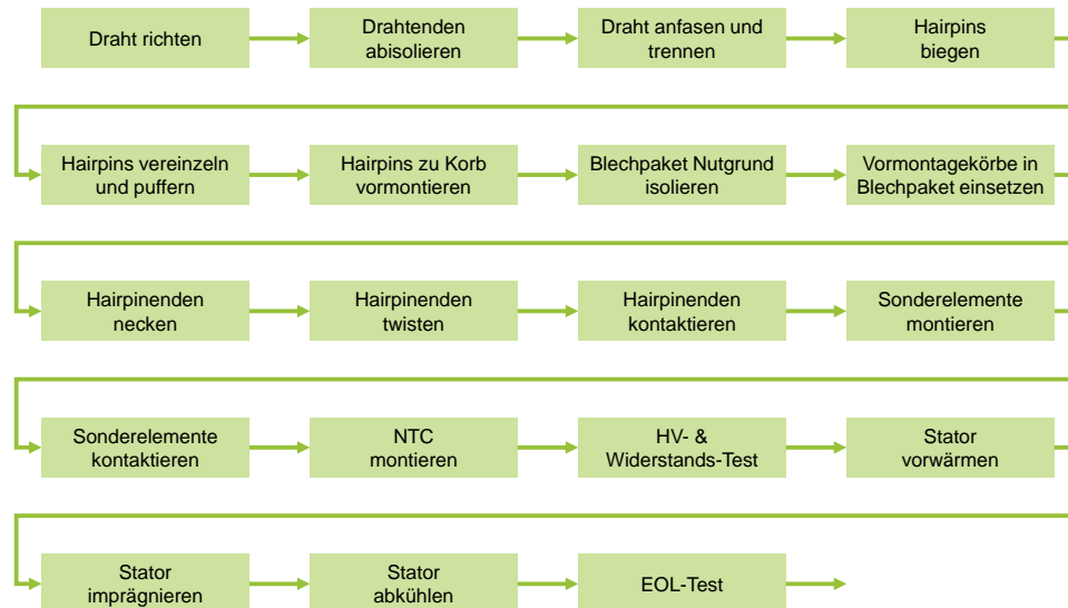
Abbildung 7: Fertigungsablauf konzipiertes Produktionssystem
