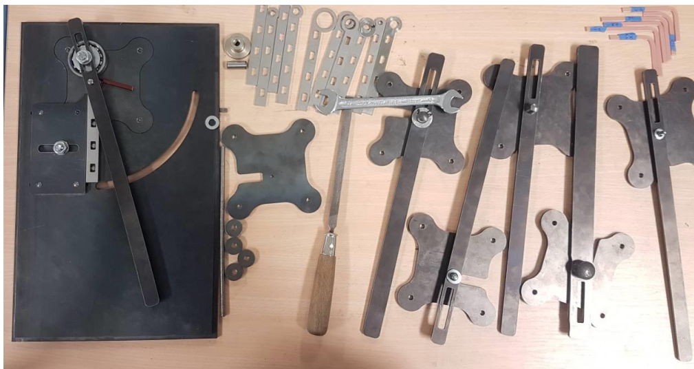
Abbildung 11: Überarbeitete Version der Rotationsbiegevorrichtung
