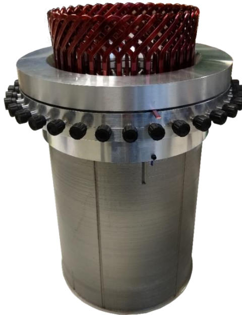
Abbildung 35: Gefügter Wickelkorb im Referenzstator vor dem Lösen des Stiftschablonenmoduls
