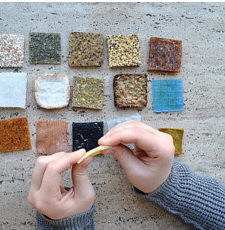
I residui del processo di trasformazione delle olive possono essere impiegati per la produzione di bio-materiali. Cecilia Cecchini
