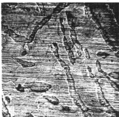
Fig. 6. 59,8 Atomproz. Sb — 40,2 Atomproz. Sn. 36 Stunden auf 400^\circ exponiert, 24 fache Vergr., geätzt mit alkoholischer \text{FeCl}_3 Lösung.
