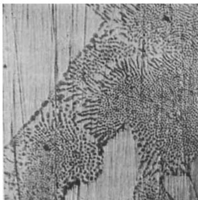
Fig. 1. 10,3 Atomproz. Mn — 89,7 Atomproz. Sb. 180fache Vergröß., geätzt mit \text{FeCl}_3 Lösung.
