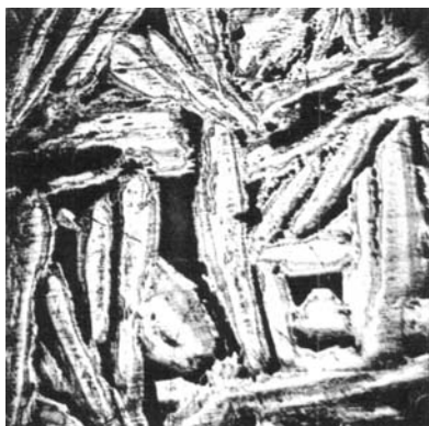
Fig. 3. 49,8 Atomproz. Sb — 50,2 Atomproz. Sn. 24 fache Vergröß., geätzt mit alkoholischer \text{FeCl}_3 Lösung.
