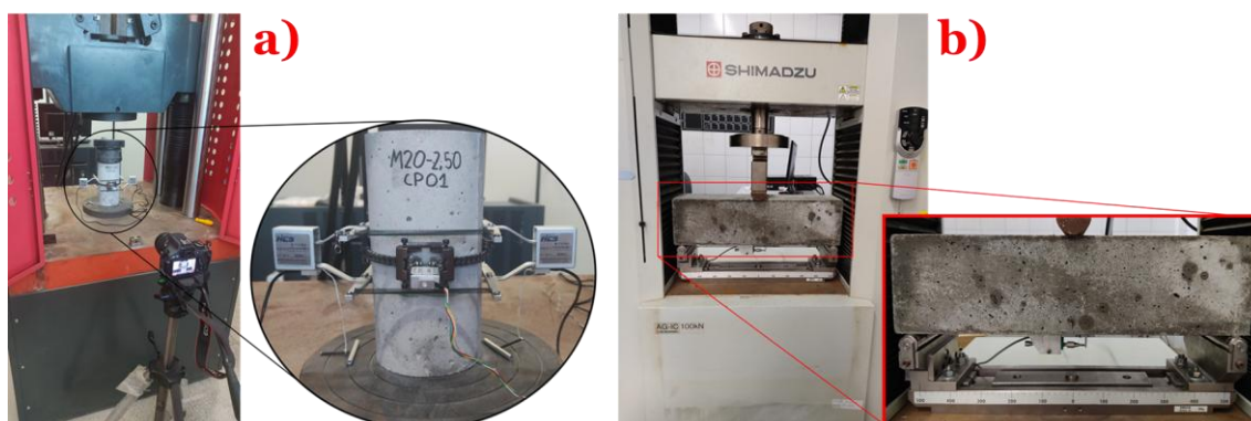
Figura 4 – Ensaio mecânicos: a) Compressão axial; b) Tração na flexão em 3 pontos.
