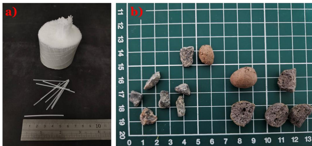
Figura 1 – Materiais: a) Macrofibras de polipropileno; b) Argila expandida.
