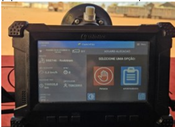
Figura 1 – Equipo de telemetría instalado en el salpicadero de un camión
