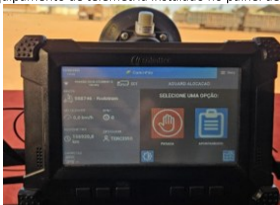
Figura 1 – Equipamento de telemetria instalado no painel de um caminhão
