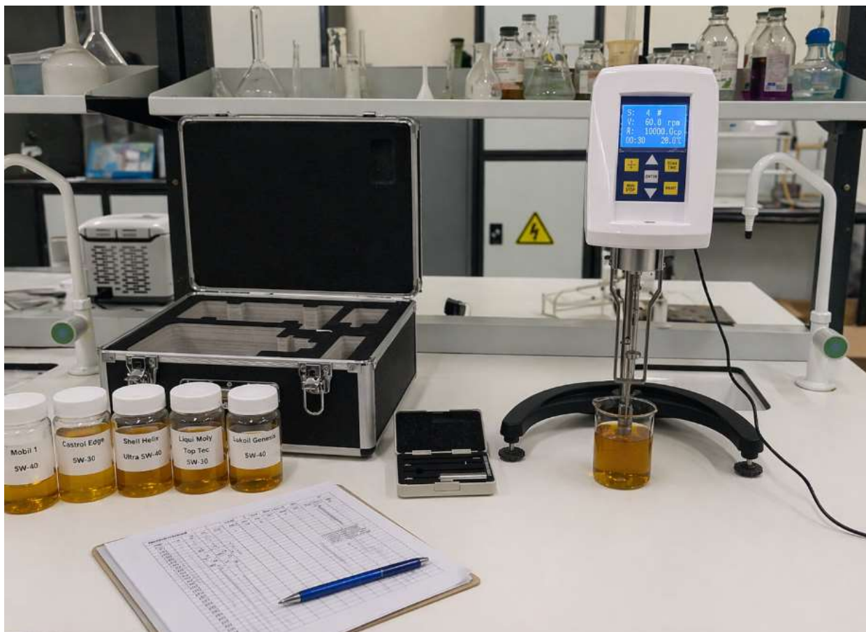
1 – rasm. PCE-RVI 2 viskozometerida avtomobil moylarini taqqoslash Jarayoni
