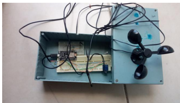
Figura 10. Integración del sensor de temperatura DS18B20 y el Anemómetro HWFS-1.
