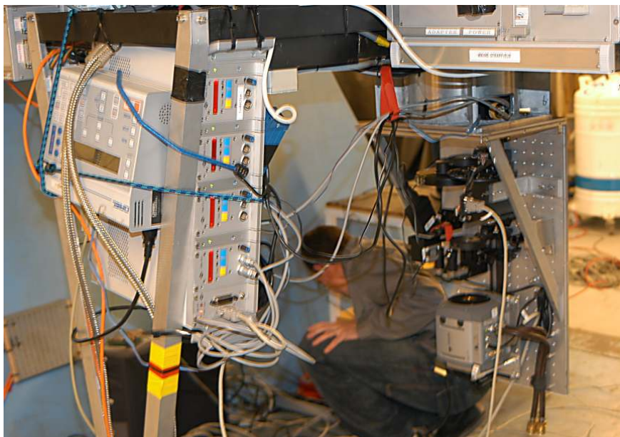
Figura 4.14: Instalación de FastCam en NOT con la rueda de motor del ADC asomando entre la estructura de acople. En primer plano los controladores de los motores utilizados. Se ve el hueco vacío del detector de campo y el brazo motor del espejo atado con cinta de velcro roja.
