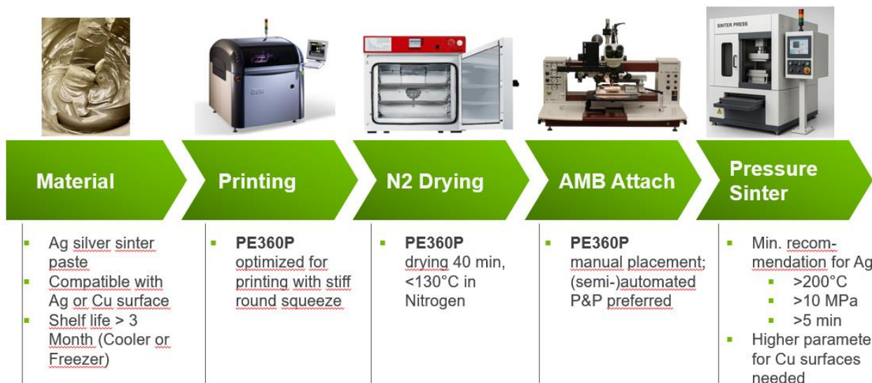
Bild 2: Prozessfluss-Empfehlungen für LAS-Drucksinterpaste mAgic® PE360P.
