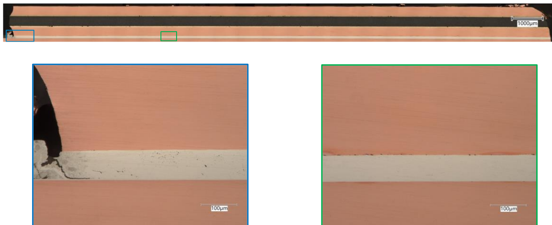
Bild 9: Sinterverbindung zwischen einer versilberten Kupfer-Bodenplatte und einem AMB-Substrat nach 1500 Zyklen.
