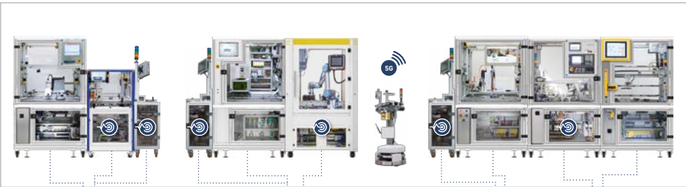
Abbildung 8: Der Produktionsprozess für die Herstellung des Visitenkartenetuis besteht derzeit aus bis zu acht verschiedenen Produktionsmodulen.
