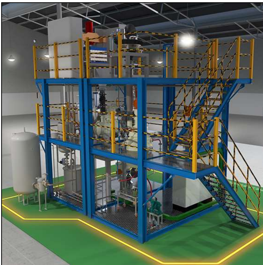
Рисунок 3. 3D-модель компоновки оборудования в пилотном цехе (площадь ~120 м 2 ).
