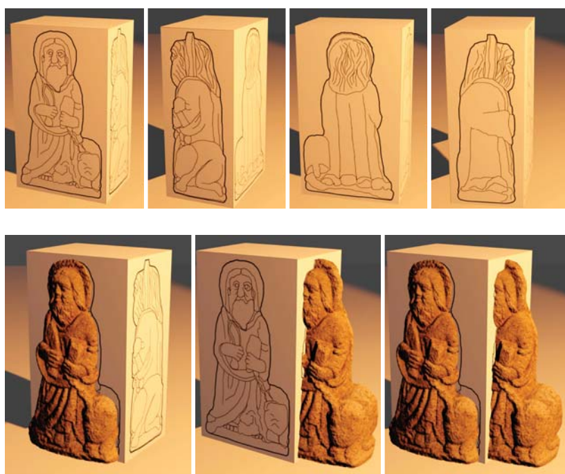
FIGS. 6 e 7 – Em cima, marcação no bloco de granito das linhas guias (esboço) para enquadrar o início do processo escultórico.
