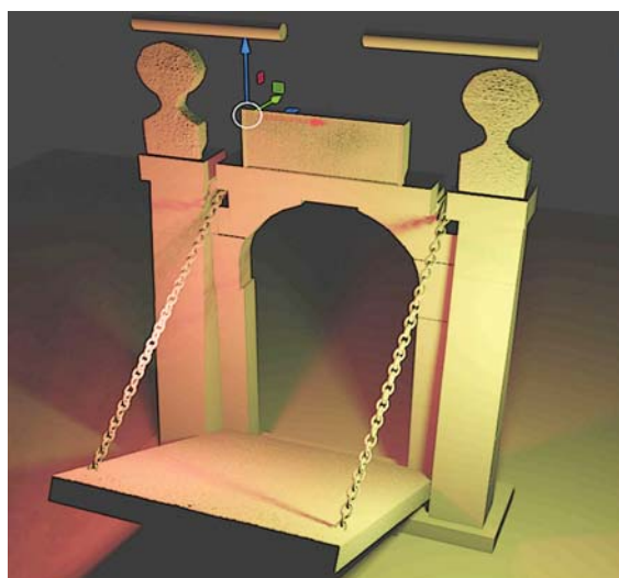
FIG. 4 – Modelo explicativo da porta Norte de acesso ao corredor central da casa-forte, com exemplificação da porta levadiça e do sistema de engrenagens no terraço, do qual restam ainda os apoios construídos em pedra calcária.
