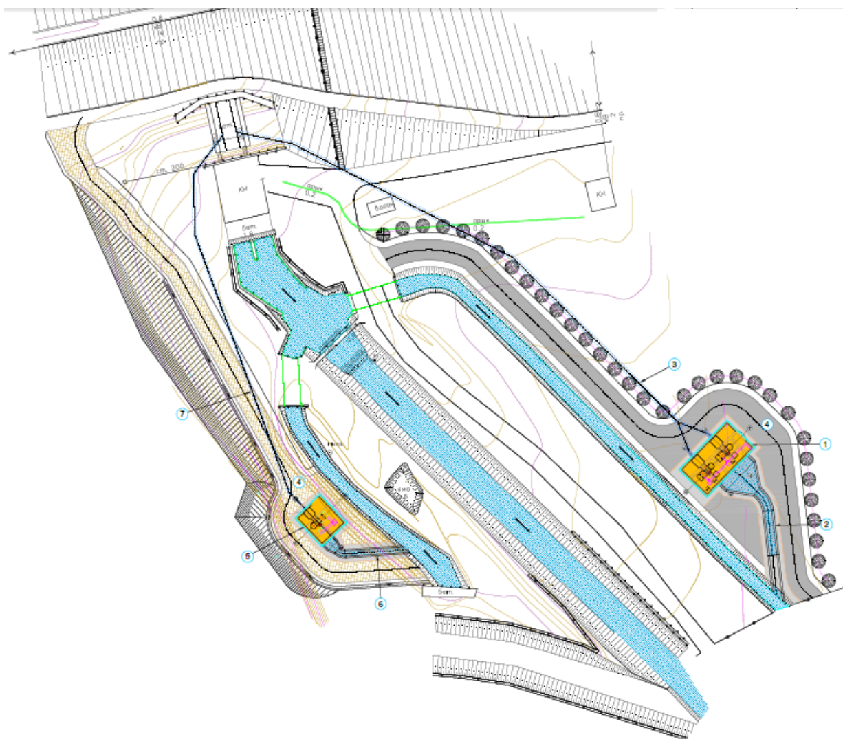
3-rasm. Chortoq suv omboriga qurilgan 825 kVt li MikroGES ning bosh rejasi
