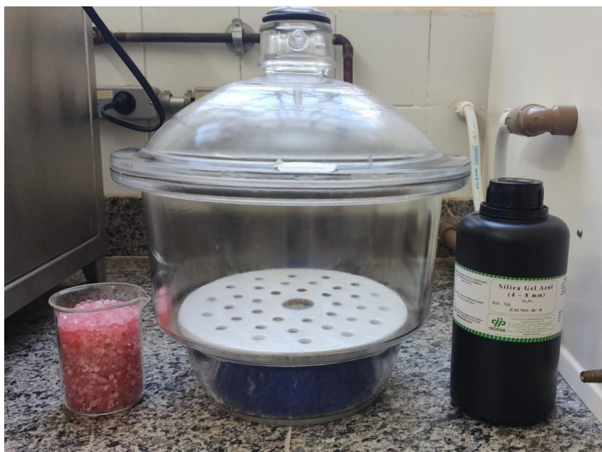
Figura 8: Dessecador e o dessecante sílica gel azul (dentro do dessecador e na embalagem original); e dentro do béquer a sílica gel azul que absorveu umidade (rosa)
