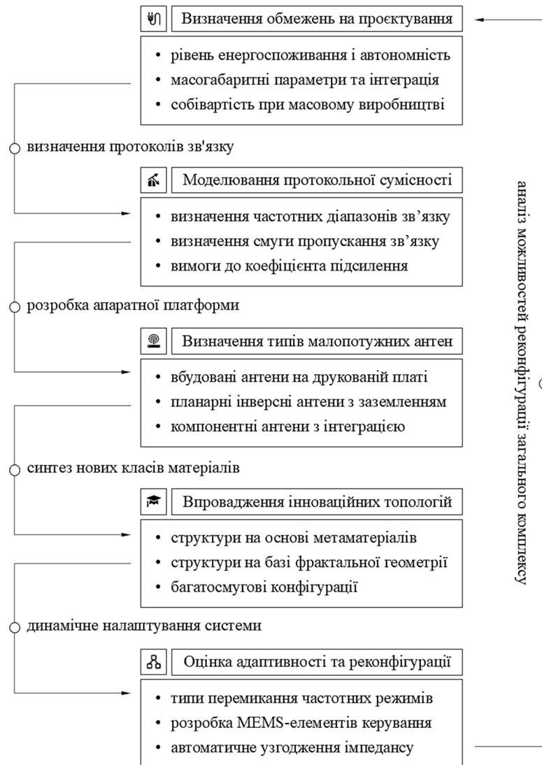
Рис. 2. Структурна схема постановки задачі проектування енергоефективної антенної підсистеми для IoT-пристроїв
