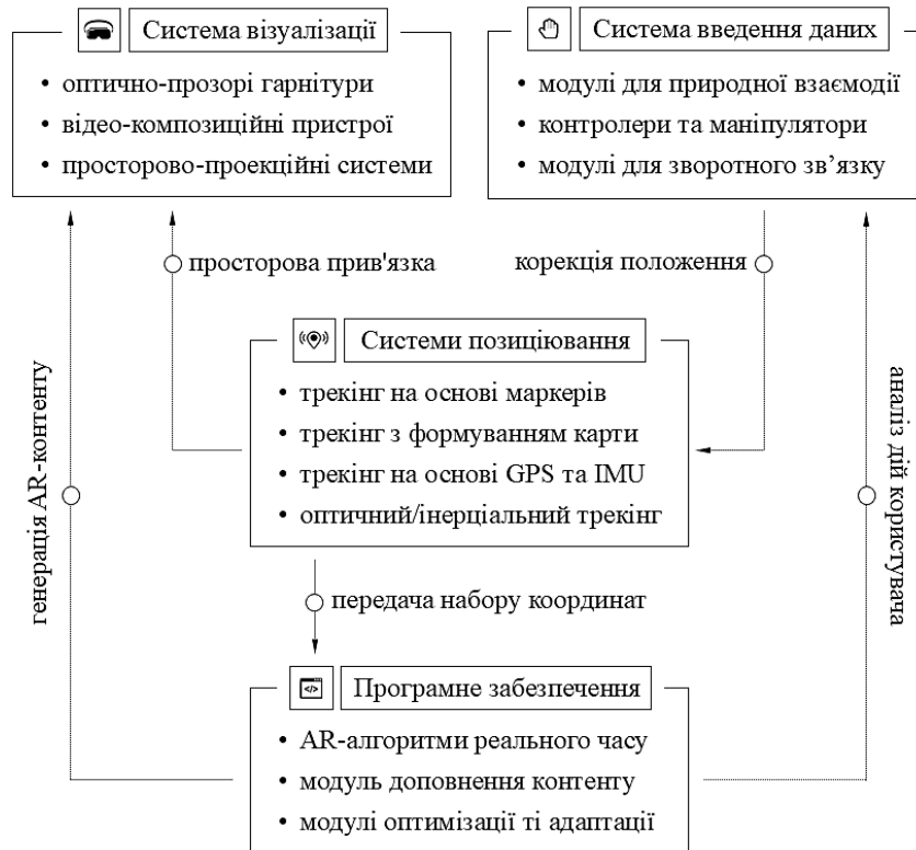
Рис. 1. Структурно-функціональна схема компонентів системи доповненої реальності для технічного навчання
