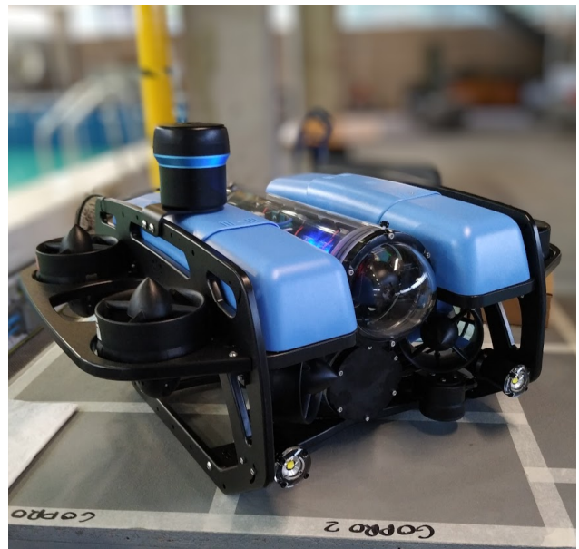
Figura 1: Imagen del BlueROV2 en su configuración pesada.
