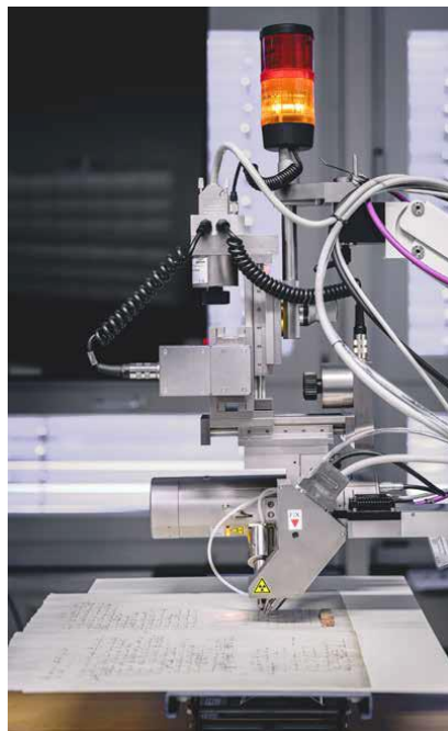
Abb. 2.1: Messkopf des mobilen Röntgenfluoreszenzspektrometers (Artax, Firma Bruker Nano GmbH) über einer Seite des Homburger Foliohefts. Foto: Marcel Katz.
