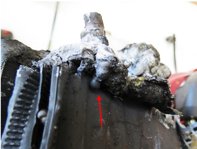
Figuras 68 e 69 - Formação de cristais de sulfato de chumbo em placas internas, indicando sulfatação avançada e curto-circuito. Fonte: Acervo pessoal.
