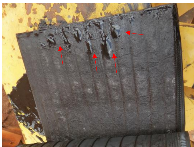
Figuras 66 e 67 - Detalham como se formam os cristais de sulfato de chumbo ( \text{PbSO}_4 ) nas placas internas positivas da bateria (dióxido de chumbo). Esse surgimento revela um estágio já avançado do processo de sulfatação, ligado a um curto-circuito interno e ao depósito de uma substância pastosa/borra de composição química complexa. Tal material consiste em resíduos originados da deterioração das placas, incluindo sulfato de chumbo ( \text{PbSO}_4 ), óxido de chumbo ( \text{PbO} ), chumbo metálico ( \text{Pb} ), dióxido de chumbo ( \text{PbO}_2 ) e ácido sulfúrico ( \text{H}_2\text{SO}_4 ), prevalecendo a cor marrom. Fonte: Acervo pessoal.
