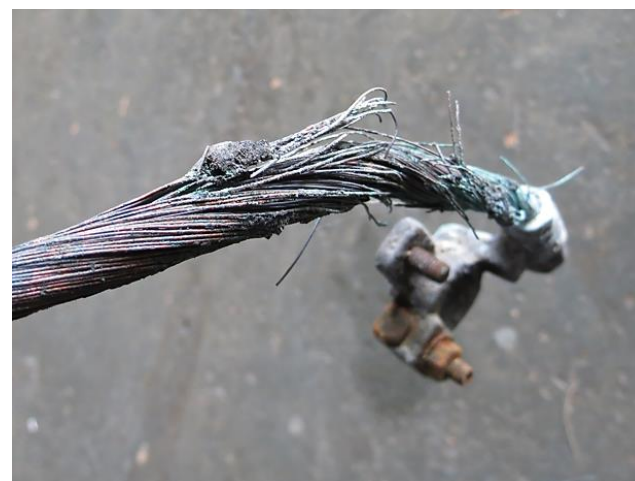
Figuras de 38 a 41 - Mostram compartimento veículo Frontier danificado por incêndio e compartimento do motor, cabo elétrico positivo e soquete com danos por ação térmica, com fusão, formação de pérolas e superaquecimento. Fonte: Acervo pessoal.
