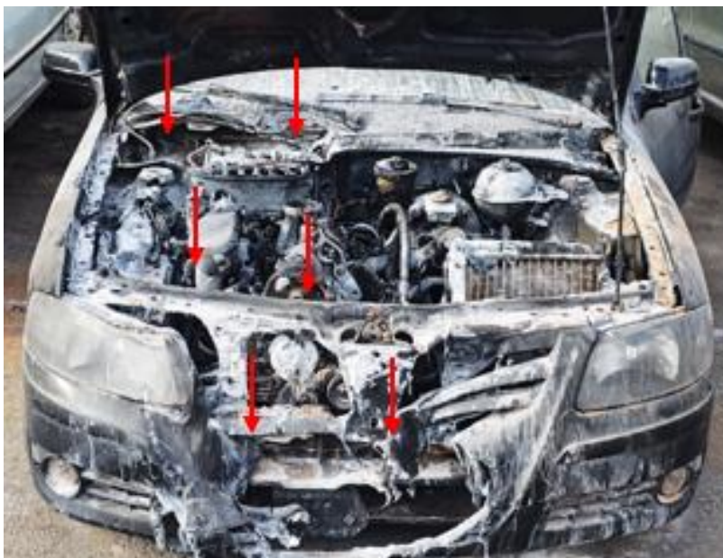
Figuras 42 e 43 - Setas vermelhas mostram motor com danos por queima e concentração do lado direito, com orientação de trás para frente. Fonte: Acervo pessoal.
