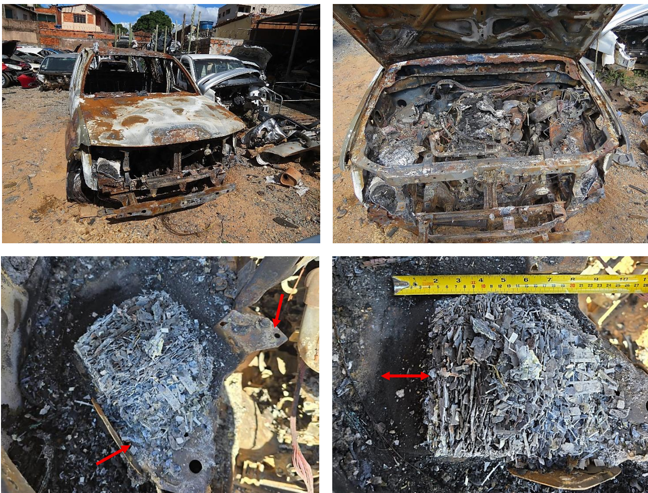
Figuras de 26 a 29 – Mostram compartimento veículo Frontier danificado por incêndio e compartimento do motor em que ocorreu a movimentação da bateria por 5 cm (cinco centímetros) devido à ausência da trava ou suporte. Fonte: Acervo pessoal.
