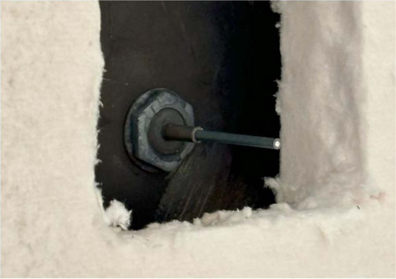
Montaje del extremo de la fibra expuesta a la radiación en el simulador solar de IMDEA Energía.
