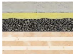
Brettsper Holz (BSP) mit gebundener Splittschüttung
