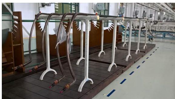
Slika 1: Prikaz statorskih štapova odabranih za kvalifikacionu proveru tehnologije fabrikacije
