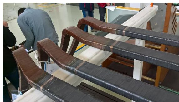
Slika 2: Uzorak statorskih štapova sa pripremljenim zarezima na OCP i formiranim zaštitnim elektrodama za merenje \tan\delta prema [8]
