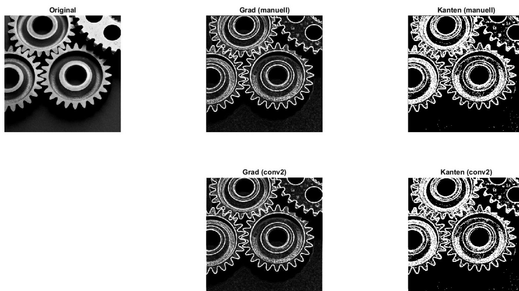
Abbildung 5.7: Kantendetektion an Zahnrädern
