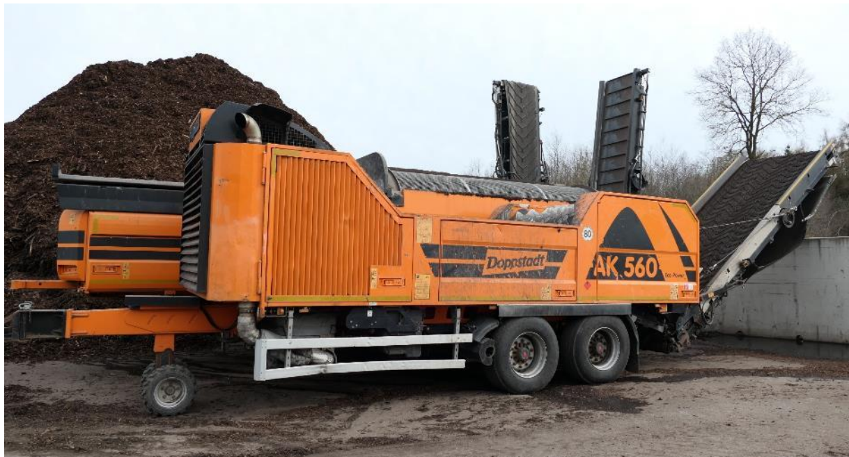
Abbildung 8: Schredder im Kompostwerk
