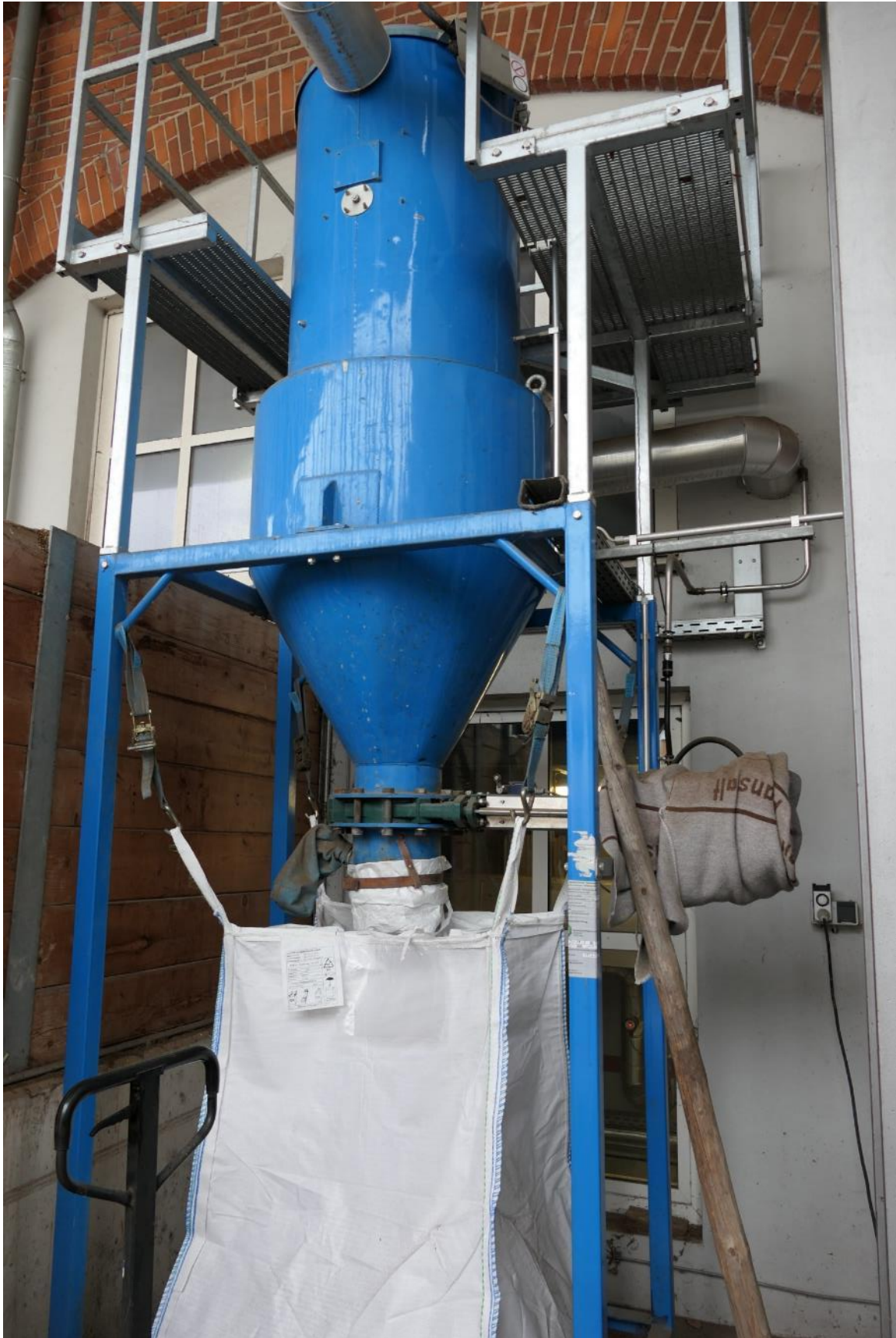
Abbildung 36: Ein Fliehkraftabscheider trennt die E-Filterasche wieder vom Luftstrom. Die Filterasche wird hier direkt in einen Big-Bag gefüllt, der sich dann einfach transportieren lässt.
