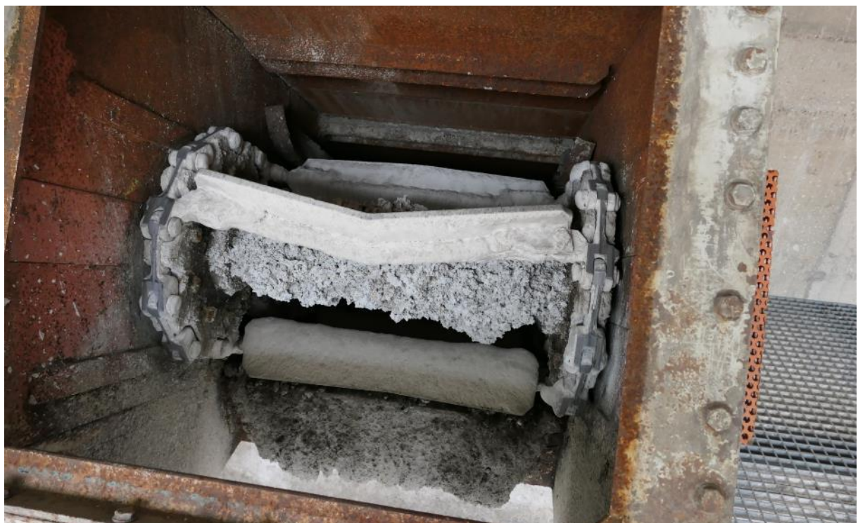
Abbildung 34: Detailansicht vom oberen Ende des Trogkettenförderers. Trogkettenförderer sind sehr robust und für die Förderung abrasiver Materialien wie Aschen gut geeignet. Die Förderkette des hier gezeigten Trogkettenförderers musste in der bisher 14-jährigen Laufzeit zweimal ausgetauscht werden.
