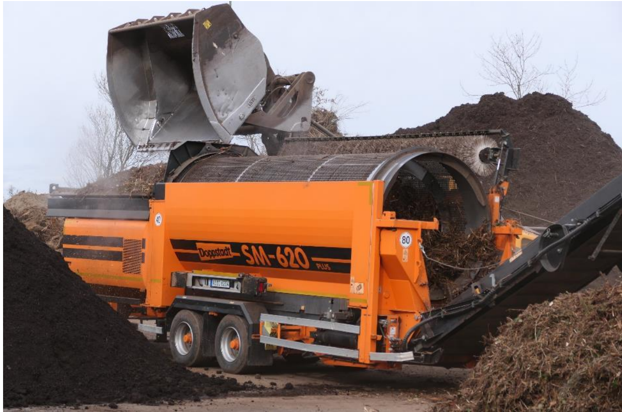
Abbildung 7: Trommelsieb im Kompostwerk
