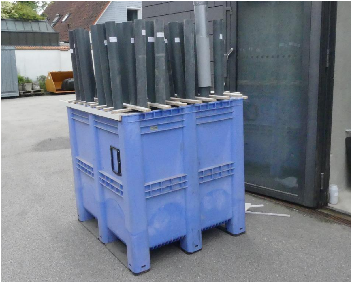
Abbildung 11: Aufrecht stehende Kunststoffrohre mit einem ähnlichen Volumen-Oberflächenverhältnis wie bei der Aschelagerung wurden als Reaktionsgefäße für die Versuche zum Chrom(VI)-Abbau verwendet.
