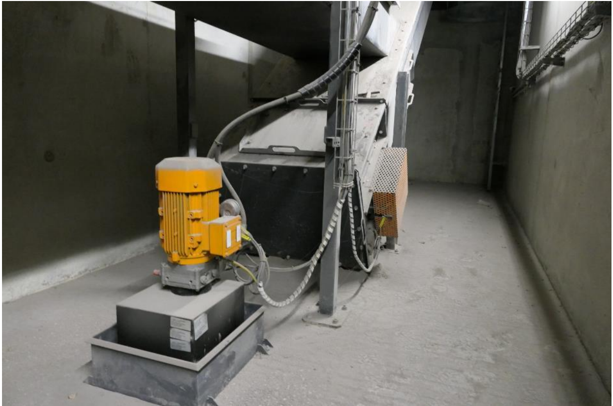
Abbildung 24: Trogkettenförderer, der die Rostaschen von einem kleinen Keller unter dem Heizkessel zum Aschecontainer vor dem Gebäude fördert
