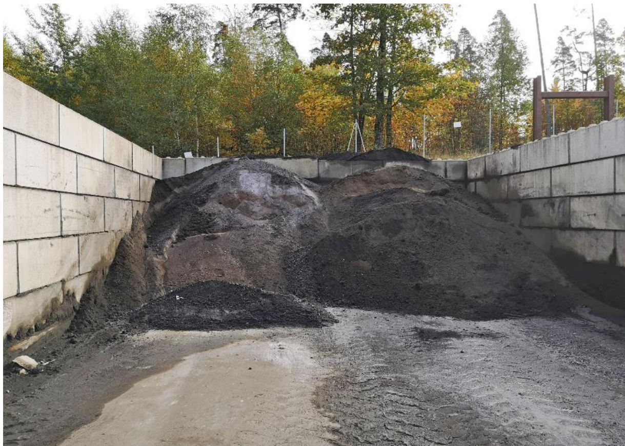
Abbildung 39: Lagerung feuchter Aschen in einem offenen Aschebunker. Diese Art der Lagerung ist kostengünstig. Die Anfeuchtung verhindert Staubemissionen. Die Asche wird in kurzen zeitlichen Abständen zum Verwerter transportiert, sodass sich die feuchte Asche nicht verfestigt.
