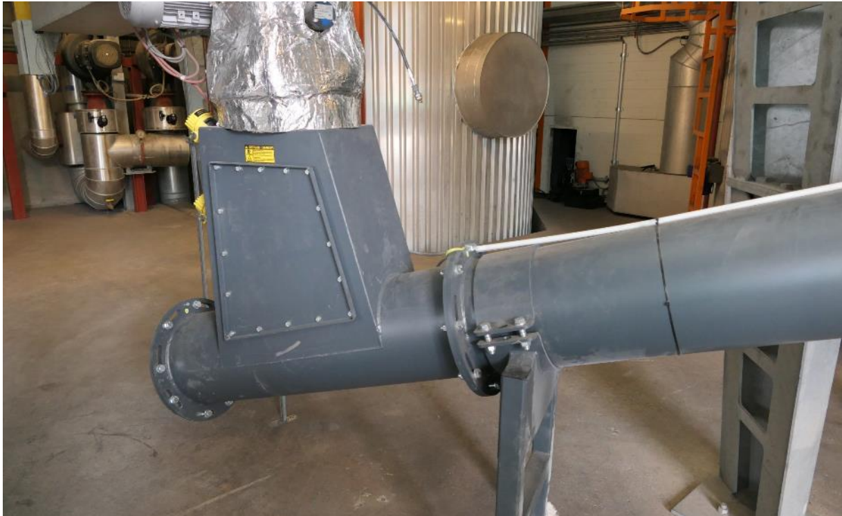
Abbildung 25: Förderung der E-Filteraschen mit einer Transportspirale. Die Förderanlage ist speziell abgedichtet. Damit soll verhindert werden, dass eindringende kühle Luft zu Kondensation und Korrosion führt, wie beim vorher verbauten Trogkettenförderer.
