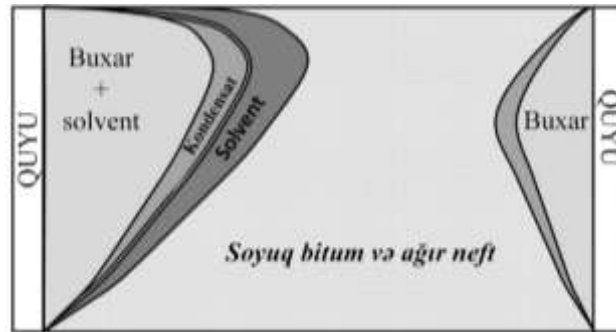
Şəkil 1. Neftverməni artırmaq üçün buxara maye əlavə edilməsi (LASER) konsepsiyası. CSS, siklik buxar stimullaşdırılması arasında müqayisə
