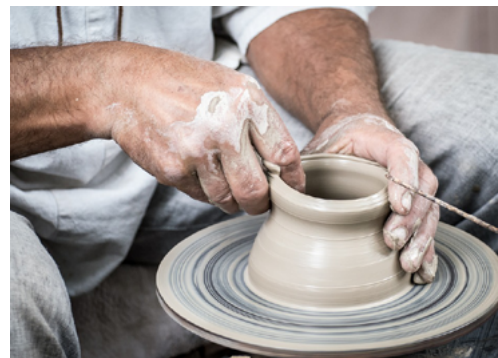
Figura 1.3 – Torneamento plástico de cerâmica 9
