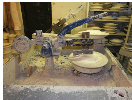
Figura 1.4 – Jigger para torneamento de prato 10
