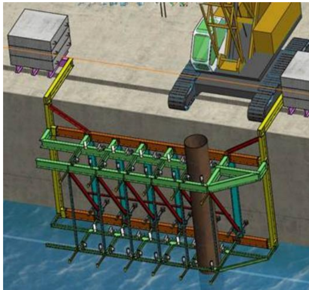
Setup para execução da cortina de estacas metálicas
