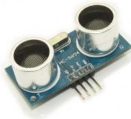
Figura. Sensor de proximidade ultrassónico – defensas marítimas
