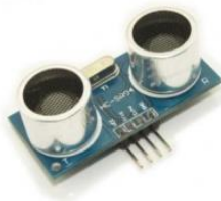
Figura. Sensor de proximidade ultrassónico – defensas marítimas
