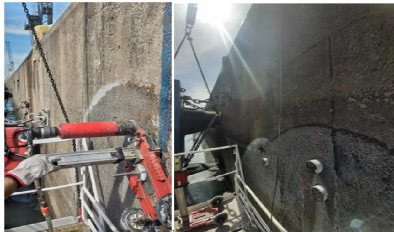
Extração de carotes, instrumentação em laboratório, reimplantação
