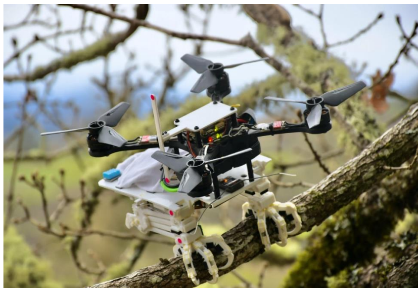
3-расм. Дарахт шохига қўна оладиган оёқли дрон.
