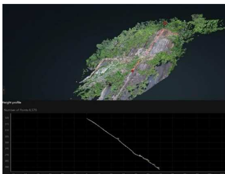
FIGURA 4 - Perfil topográfico da região costeira do Morro do Vidigal, construído a partir dos dados adquiridos por imagens de drone . Elaboração própria.
