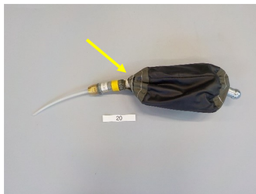
Blaas meting 20; Brandschade en scheur in de blaas.
