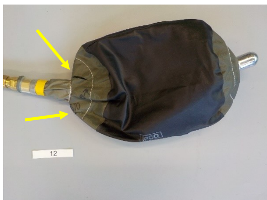
Blaas meting 12; Brandschade leidend tot een scheur.
