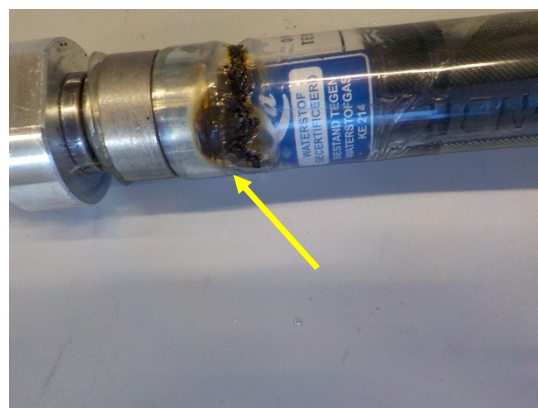
Blaas meting 16; Smeltschade aan de aansluiting van de blaas.
