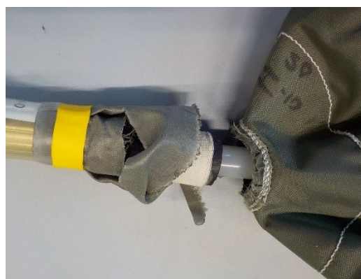
Blaas meting 35; Detail van de scheur.
