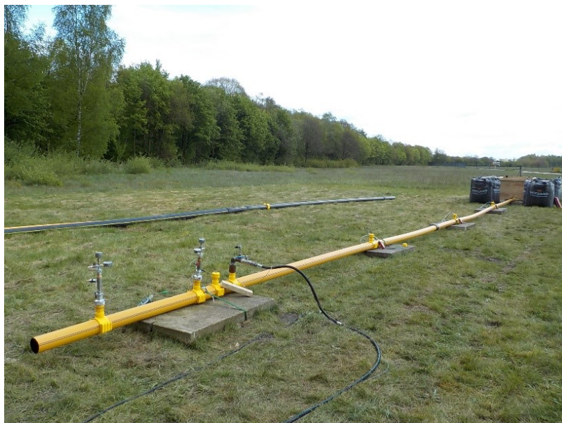
Foto 7 De testopstelling met de buis met diameter 110 mm met daarin 2 blazen.
