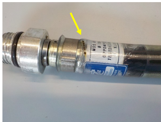
Blaas meting 9; Smeltschade aan de aansluiting van de blaas.
