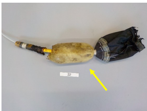
Blaas meting 22; Volledig gescheurde blaas als gevolg van brand (bij uitnemen zo gevormd).
