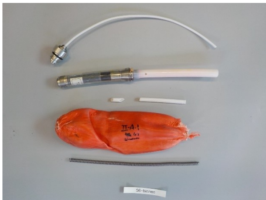
Binnenste blaas meting 56; De blaas is gescheurd en losgeraakt van de aansluiting.
