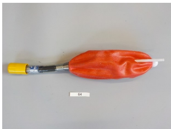
Blaas meting 64; De vul-meetslang is door de blaas gestoken.
