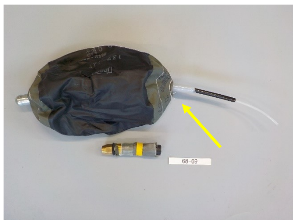
Buitenste blaas 69; De blaas is volledig gescheurd. De aansluiting is van de blaas losgeraakt.
