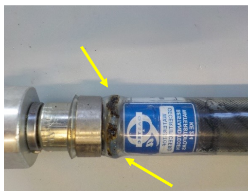
Blaas meting 7; Smeltschade aan de aansluiting van de blaas
