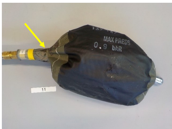
Blaas meting 11; Brandschade aan de blaas c.q. aansluitleiding.
