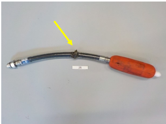
Blaas meting 26; smeltschade aan de aansluiting van de blaas
