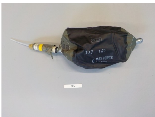
Blaas meting 35; De blaas is volledig gescheurd
