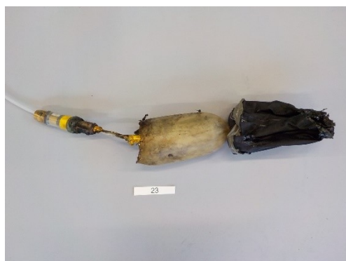
Blaas meting 23; Volledig gescheurde blaas als gevolg van brand (bij uitnemen zo gevormd).
