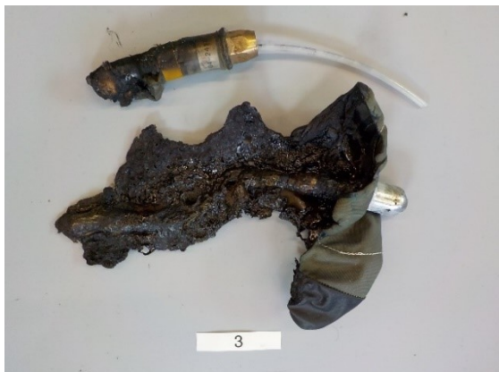
Blaas meting 3; De blaas is nagenoeg volledig verbrand.
