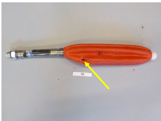
Blaas meting 16; Brandschade en scheur in de blaas.
