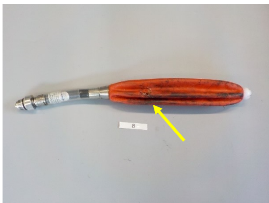
Blaas meting 8; Brandschade aan de blaas en een scheur.
