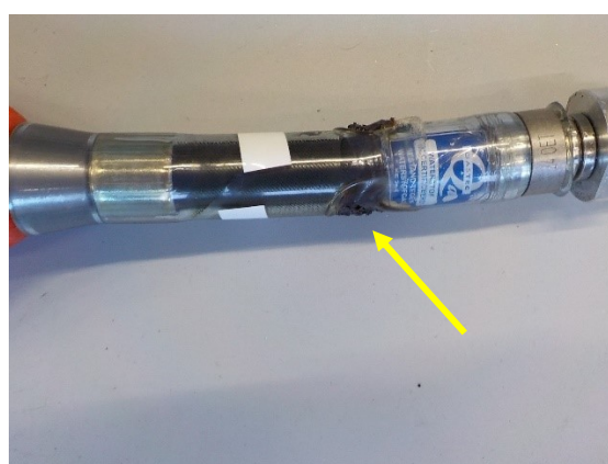
Blaas meting 14; Smeltschade aan de aansluiting van de blaas.
