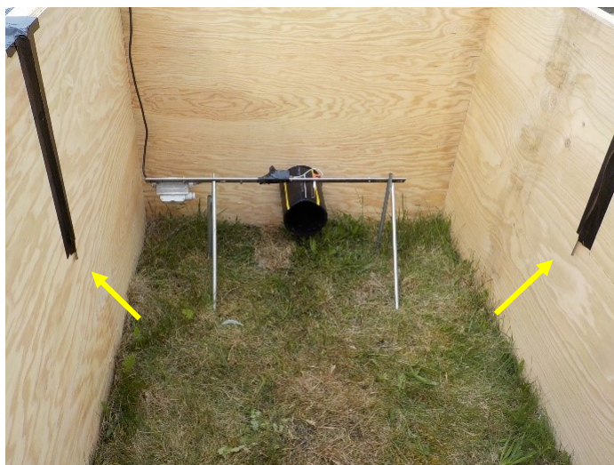
Foto 6 De positie van de meetpunten voor de concentraties in de werkput bij het doven van een aardgas- of waterstofbrand
