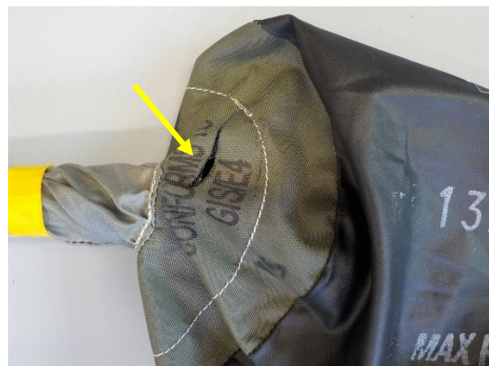
Blaas meting 12; Brandschade leidend tot een scheur.
