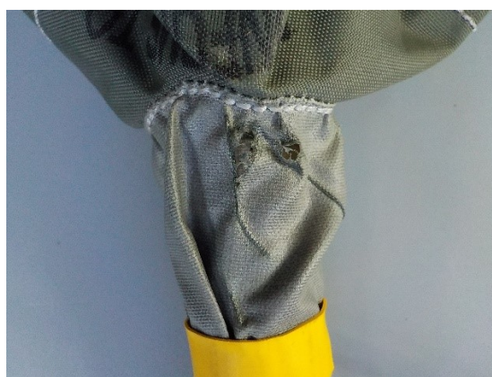
Blaas meting 11; Brandschade aan de blaas c.q. aansluitleiding.
