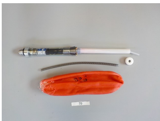
Blaas 70; De blaas is gescheurd en losgeraakt van de aansluiting.
