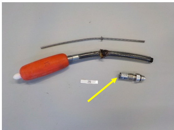
Blaas meting 29; Smeltschade aan de aansluiting van de blaas. Deze moest losgezaagd worden om uit lans en buis te krijgen.
