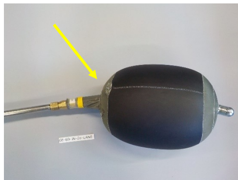
Blaas 69 in binnenste lans; Scheuren in buitenste laag (ten tijde van het experiment was de blaas niet opgeblazen).
