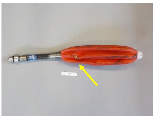
Blaas meting 7; Brandschade aan de blaas en een scheur.
