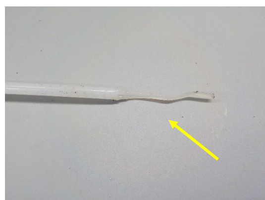
Blaas meting 28; smeltschade - vulslang (inwendig) gesmolten
