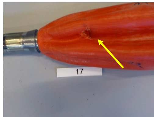
Blaas meting 17; Brandschade en scheur in de blaas.
