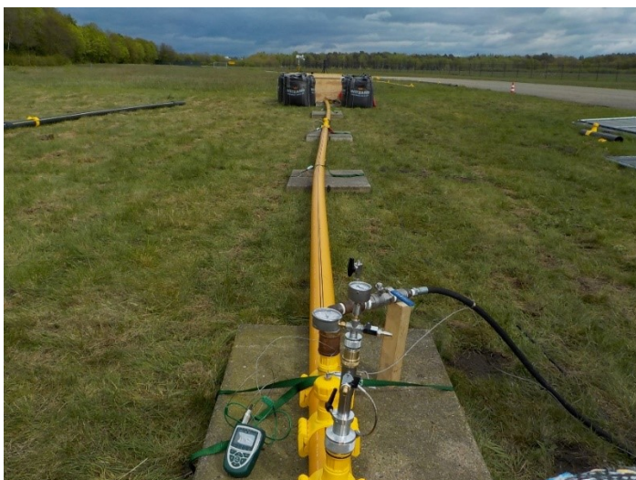
Foto 1 De opstelling met de buis met diameter 110 mm van 20 meter
