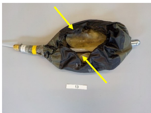
Blaas meting 13; Volledig gescheurde blaas als gevolg van brand.
