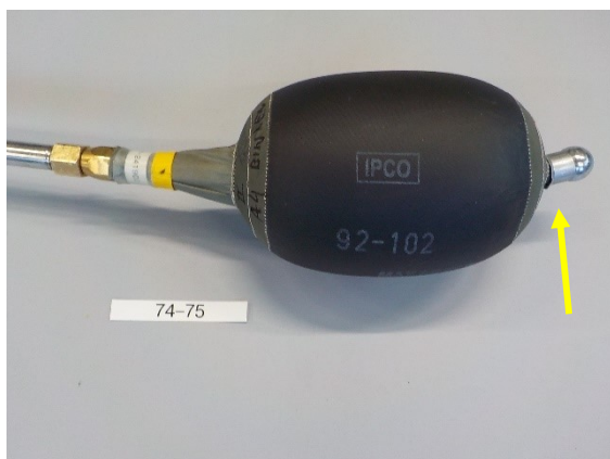
Blaas 70; De blaas is gescheurd en losgeraakt van de aansluiting.
