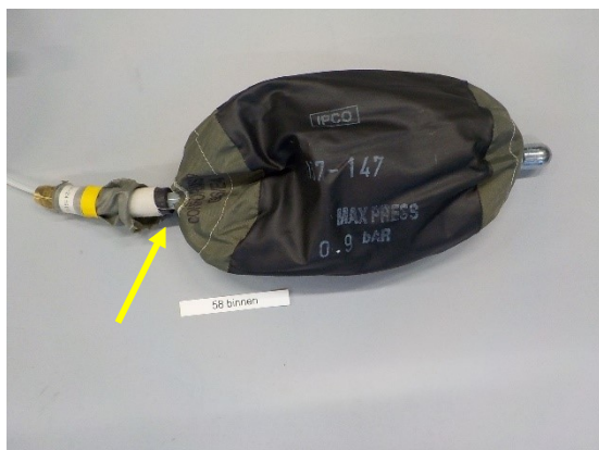
Binnenste blaas meting 58; De blaas is volledig gescheurd.
