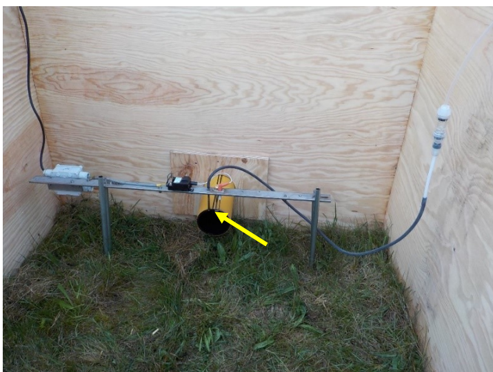
Foto 2 Positie van de vonkontsteker en het meetpunt nabij de uitstroomopening
