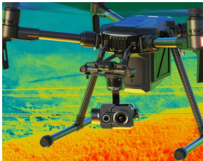
Figura 2 – Drone modelo Matrice 210 RTK v2 equipado com sensor RGBIT modelo Zenmuse XT2.
