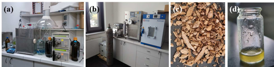
Obr. 1 (a) Zařízení pro extrakci podkritickou vodou, (b) zařízení pro extrakci superkritickým CO 2 (s nebo bez pomocného rozpouštědla), (c) kostní štěpy po extrakci, (d) extrahovaný produkt na bázi mastných kyselin.
