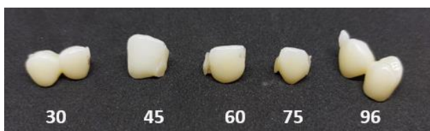
Obr. 2: Vzorky zirkónového mostíka ZP po 6 mesiacoch v kyseline sírovej (30 – 96 %)
