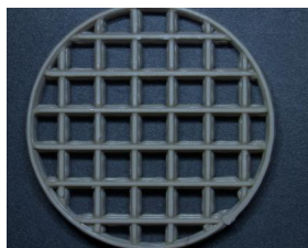
Obrázok 1: Prvý objekt napísaný a vytlačený pomocou FullControl
