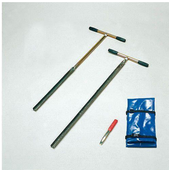
Figuur 7.1.: Links (Foto 1): Set van gutsboren voor gebruik in zachte gronden ©Eijkelkamp; Rechts (Foto 2): Set van gutsboren voor een iets hardere bodem. De gutsen zijn voorzien van een slagkop waarop men met een terugslagvrije hamer kan slaan om de guts dieper in de grond te brengen. ©Eijkelkamp
