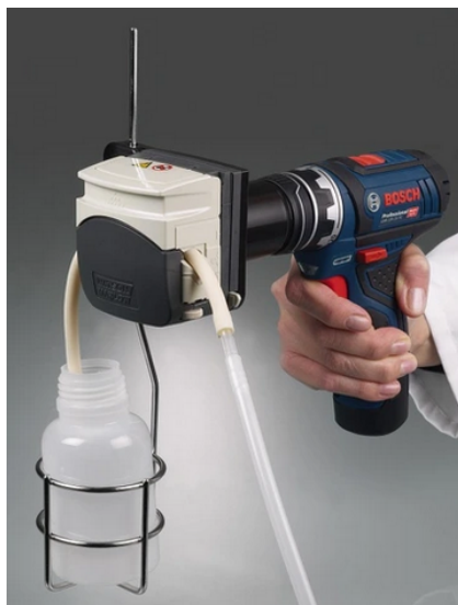
Figuur 7.2.: Foto Boormachine met peristaltische kop
