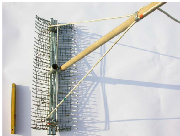
Figuur 7.3.: Dubbelzijdige dregghark, voorzien van een houten steel, bevestigd aan een lang nylonkoord (foto Jo Packet).
