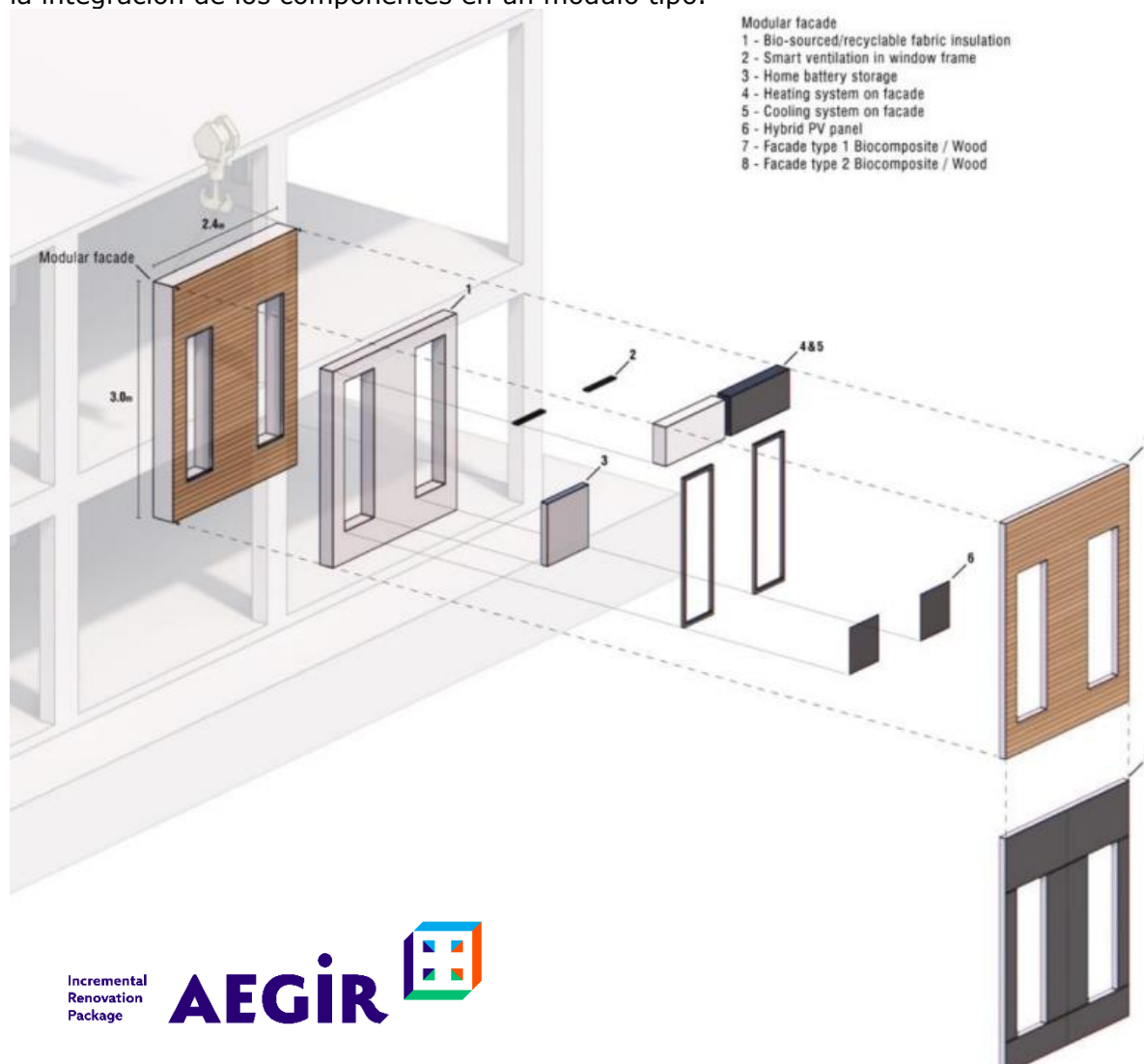
Ilustración 8: Esquema de uno de los módulos de fachada y su implementación en el edificio (UNStudio®)
