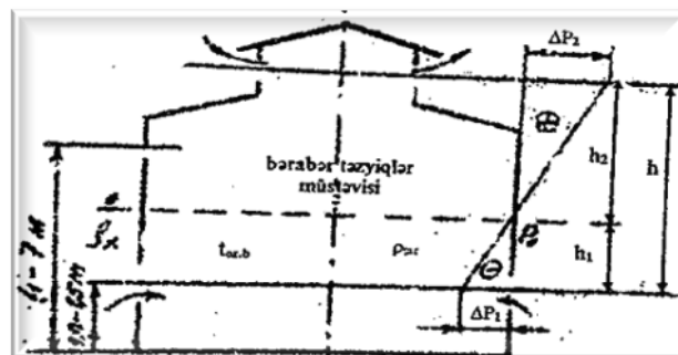
Şəkil 5. Sənaye müəssisələrinin istehsalat binalarının hündürlüyü boyunca təzyiqin paylanması.
