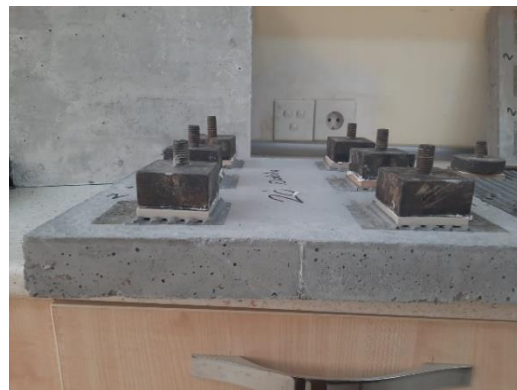
Şəkil 4. Sınaqda istifadə olunan beton piltəsi, yapışdırıcı nümunəsi və qoparma başlıqları.
