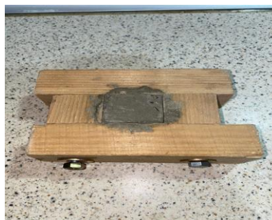
Şəkil 2. 16×4×4 sm və 4×4×4 sm ölçülü qəliblərdə hazırlanmış beton nümunələr.
