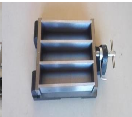
Şəkil 7. 40x40x160mm ölçülü polad qəblər
