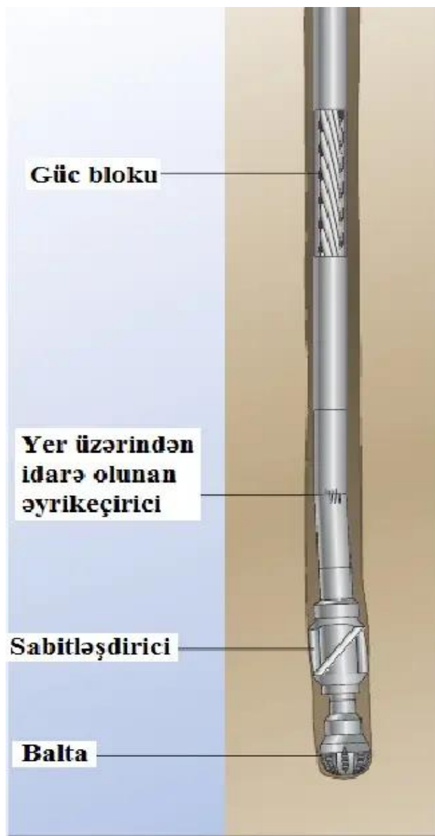
Şəkil 2. İdarə olunan hidravliki quyudibi mühərrikli yığım.
