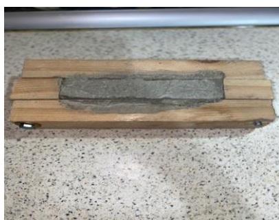
Şəkil 2. 16×4×4 sm və 4×4×4 sm ölçülü qəliblərdə hazırlanmış beton nümunələr.
