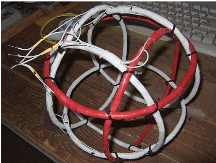
Рис. 2. Трехмерная система колец Гельмгольца устройства ДЖМ-4 для измерения магнитной восприимчивости рудного материала в однородном магнитном поле в трех направлениях
