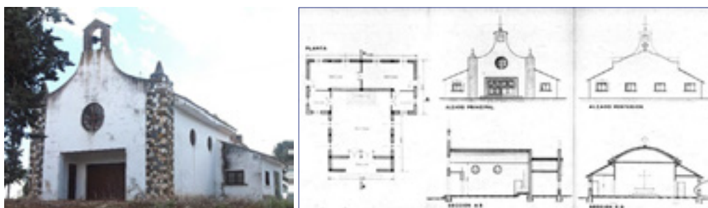
Figura 9. Capilla-escuela. La cubierta consiste en una bóveda formada por tres roscas de ladrillos, con directriz parabólica.
