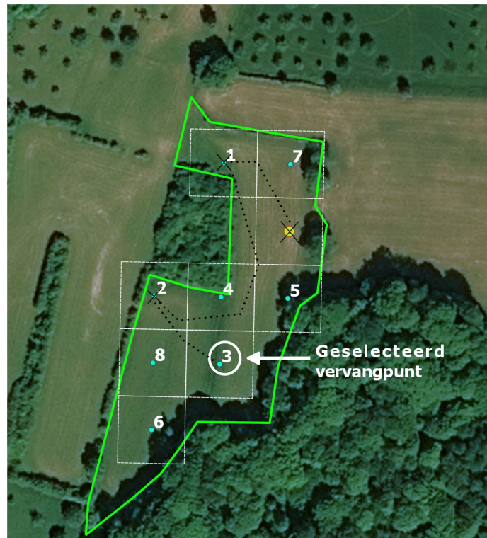
Figuur 8.3.: De geselecteerde steekprofeenheid (met gele centroïde) is niet geschikt. De rastercellenn worden in volgorde afgelopen en beoordeeld tot een geschikte rastercel wordt gevonden
