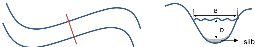
Figuur 8.2.: Situering doorsnee dwarsprofiel (rood, links) en op te nemen kenmerken van het dwarsprofiel (rechts)
